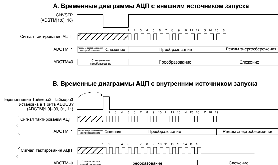
Рисунок 6.2. Временные диаграммы процесса преобразования
