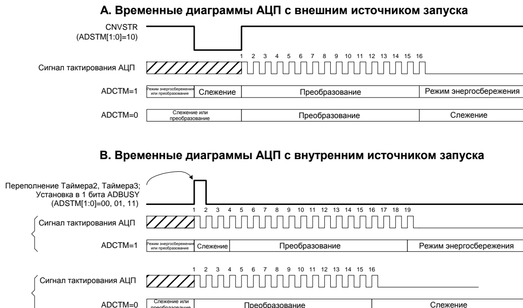
Рисунок 5.2. Временные диаграммы процесса преобразования
